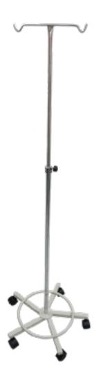
Fabricado en tubo redondo de 7/8 C.18 en acero cold rolled pintado y tubo redondo 5/8 C.18 en acero inoxidable ref. 304.
