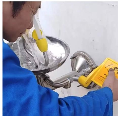
Los lavaojos para laboratorio son dispositivos de seguridad esenciales diseñados para proporcionar una rápida y efectiva irrigación de los ojos en caso de exposición a productos químicos peligrosos, partículas extrañas u otras sustancias irritantes en un entorno de laboratorio. Aquí tienes una descripción general de las características comunes de un lavaojos de laboratorio:
